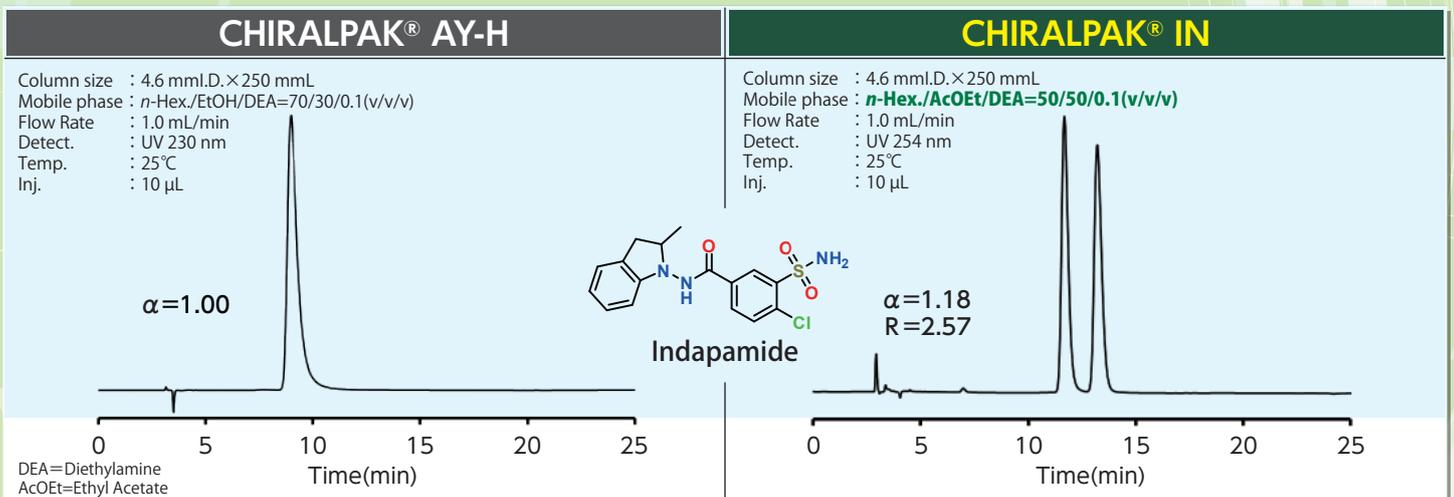
3µmタイプのキラルカラムを使用することにより、分離度(R)が向上します。
