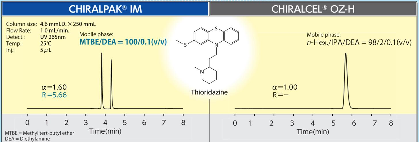
3μmタイプのキラルカラムを使用することにより、分離度(R)が向上します。
