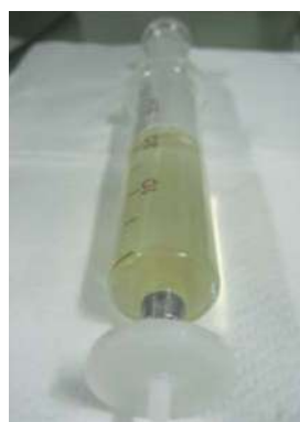
③ シリンジの先端にカートリッジ式のメンブレンフィルター (0.5 \mu\text{m} 程度) を装着します※2
