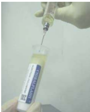
① インジェクションカラムにサンプル溶液を注入します※1
