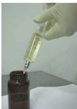
② シリンジを用いてサンプル溶液を吸引します
