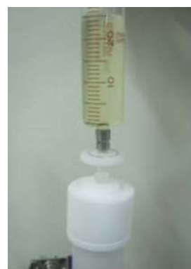
④ サンプルを CHIRALFLASH カラムに注入します
