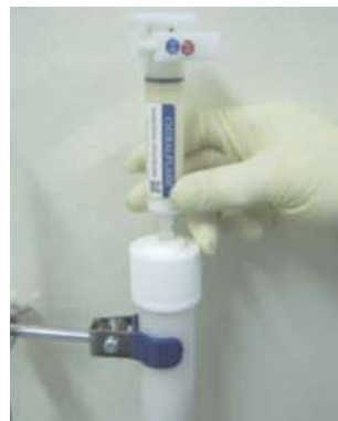
③ インジェクションカラムにカラム栓とカラムホルダーを装着し、CHIRALFLASH カラムに接続します
