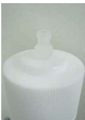
① CHIRALFLASH カラムの入口にインジェクションジョイントを接続します
